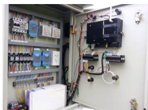
Fig. 1-1 遠隔I/Oモジュールと産業用パネルPC
