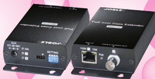
【IP09CPR(Receiver)】 電源接続側 同軸ケーブル接続側
