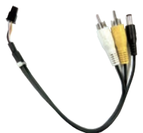
映像/音声出力ケーブル 映像(コンポジット)と音声出力(RCAオス) と電源出力(DCプラグ φ2.1×5.5mm) ※電源出力はカメラ電源出力と合計で1A
