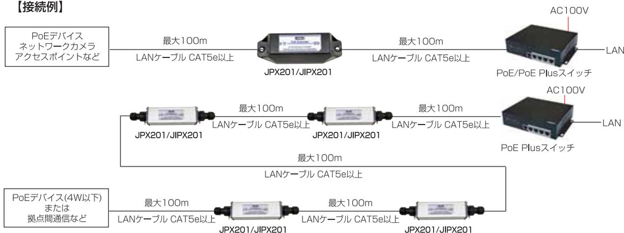
※PoEスイッチ/PoEインジェクターなど「PSE」からのケーブルを「PoE IN」側に、ネットワークカメラなど「PD」に接続するケーブルを「PoE OUT」側に接続してください。
