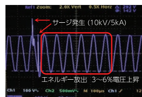
【サージ発生時の出力側電圧波形】
