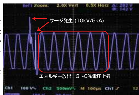
【サージ発生時の出力側電圧波形】
