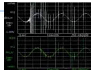
電磁パルスによるサージ 上:入力 下:出力
